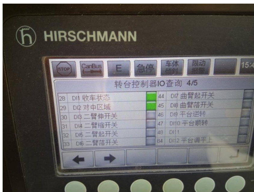
Figura 4-24 Interface de detecção de porta do controlador
