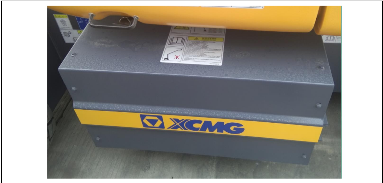
Figura 4-19 Caixas de bateria em ambos os lados da armação
